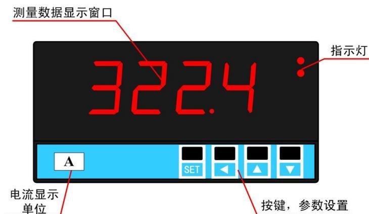
**说明:** 四位LED数码管实时显示电流测量值,上图显示电流测量值为322.4A; 两个指示灯分别为AL1, AL2为两路报警指示灯,报警继电器动作时,对应指示灯亮,报警继电器恢复,对应指示灯灭。
