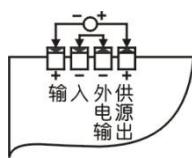
(4) 仪表与 3 线制电压、电流变送器的接线
