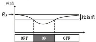
HLPS 表示 总值与给定值  $\bar{A}u$  的偏差绝对值 > 比较值时，输出导通
