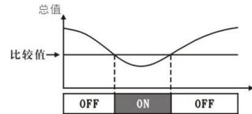
HP-S 表示总值与给定值  $\bar{A}u$  的正偏差 > 比较值时，输出导通
